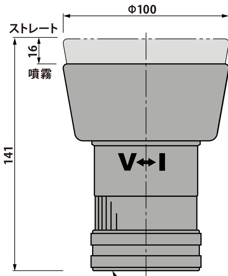
呼び65 消防用ノズルチップ雌結合金具
